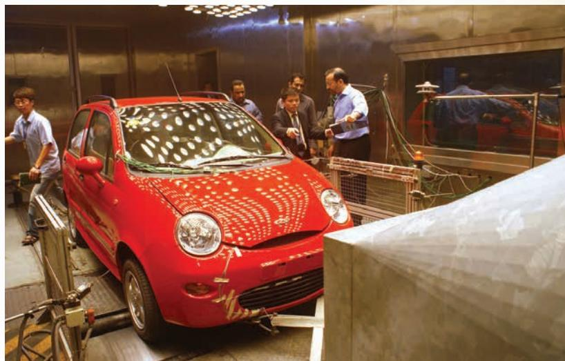
السيارة، وقد تم ضبط حرارة الجو المحيط على ٤٥ درجة مئوية، وقد تم إجراء الاختبار على أربع مراحل وتم تزويد أعضاء الوفد بنسخ من تقرير الاختبار. وتم وضع مسحات لقياس درجة الحرارة في الواقع التالية من السيارة:
